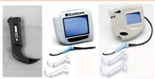
图2 适用于小儿的原始型号（A）、Cobalt型（B）和Ranger型（C）GlideScope视频喉镜
